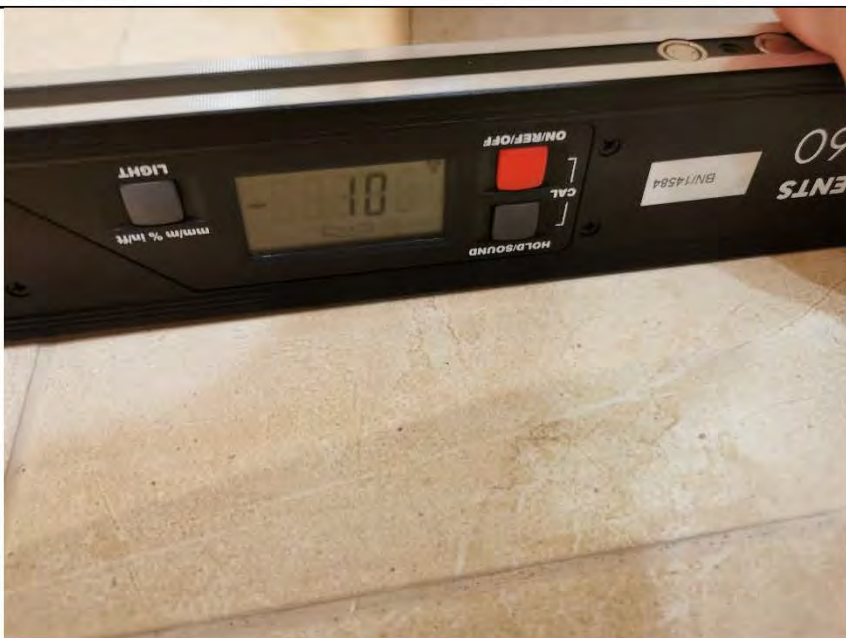
Фото №23. Измерение уровня пола в ванной комнате.
