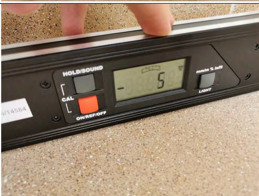
Фото №24. Измерение уровня пола в лоджии.
