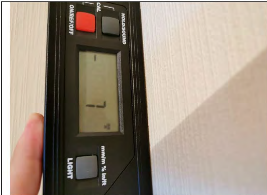
Фото №7. Измерение уровня стен в коридоре.
